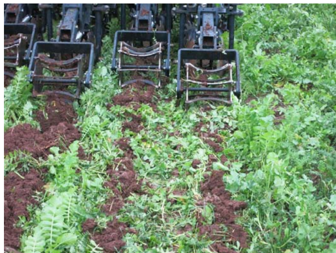
Abb. 1: Streifenbearbeitungsgerät mit Zinken- und Scheibenwerkzeugen (Quelle: Landwirtschaftliche Lehranstalten Triesdorf)
